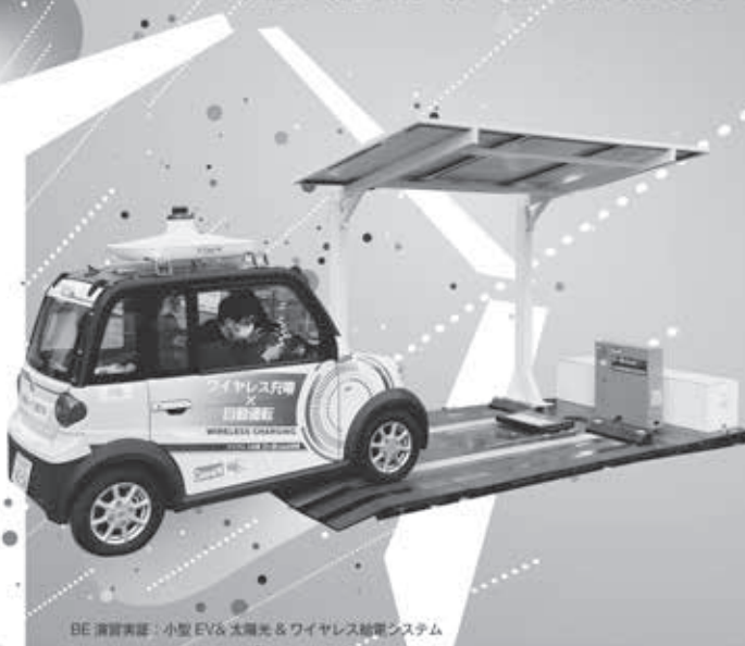
BE 演習実証：小型EV&太陽光&ワイヤレス給電システム
