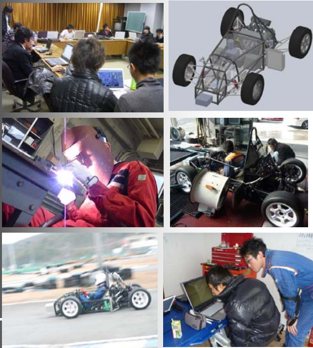
左上から:設計作業 各パーツ間での相談によりベストな解を探す/3次元CAD PC上で車両を組み立てる/製作 溶接も自分たちで行う/ダイナモ試験 セッティングを変更しながらエンジン出力を測定/テスト走行 考えるだけでは分からないものは実際の走行で/ドライバーミーティング 走行データとドライバーの感覚を照らし合わせ、車両の性能を引き出せるドライバーを目指す
