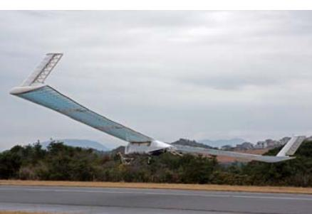
製作した飛行機が問題なく飛行するかを実際に飛ばすことによって検証します。得られたデータをフィードバックし、さらなる改良を施していく。最終的には鳥取砂丘で長距離飛行を行い、データを取るとともに、パイロットは実戦を想定した操縦の訓練を行います。
