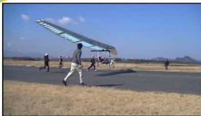
機体の強度を確かめるための**荷重試験**をしたり、実際に飛行場に行って**テストフライト**をします。テストフライトでは、機体が設計通りの機体特性をしているかを確認すると同時に、パイロットが操舵感覚を身につけます。テストフライトの回数を重ねるごとに、より安定に飛行できるようになります。
