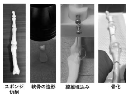
図 2.28 筋骨格ロボットを自動造形するための深層生体模倣プリンティング
