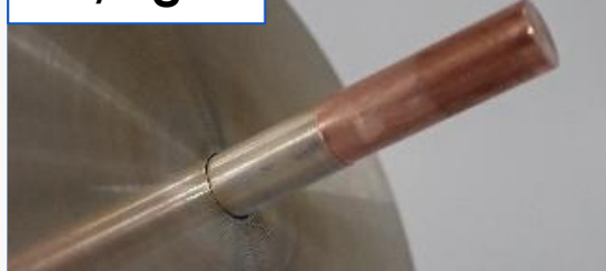
図：H 2 プラズマ（上）、プラズマ処理で接合されたCu/Ag棒（下）
