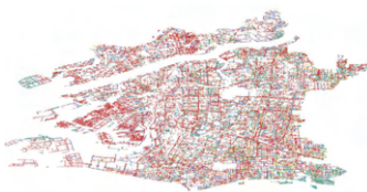
都市全体の下水道管の劣化予測シミュレーション（2050 年度）
